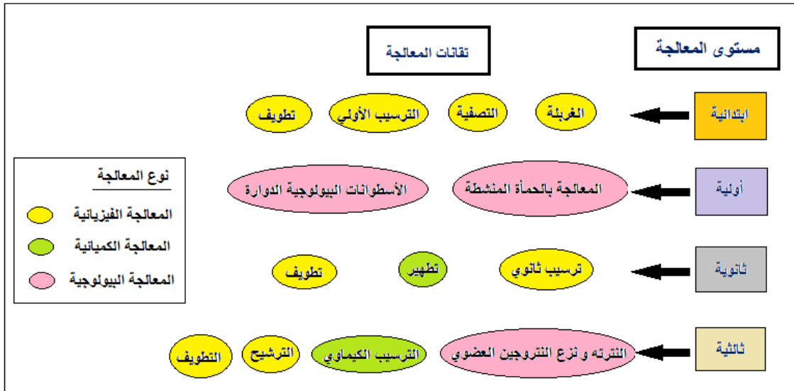
الشكل 2. أهم التقنيات المستخدمة في كل مستوى من مستويات المعالجة
