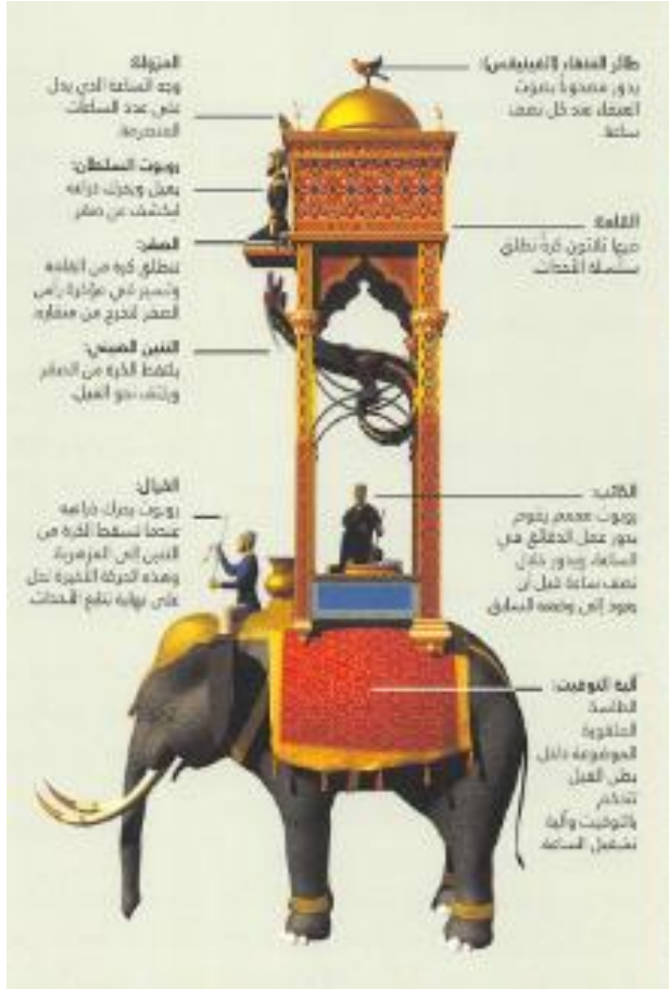
الشكل 4. كيفية عمل ساعة الفيل [14]
